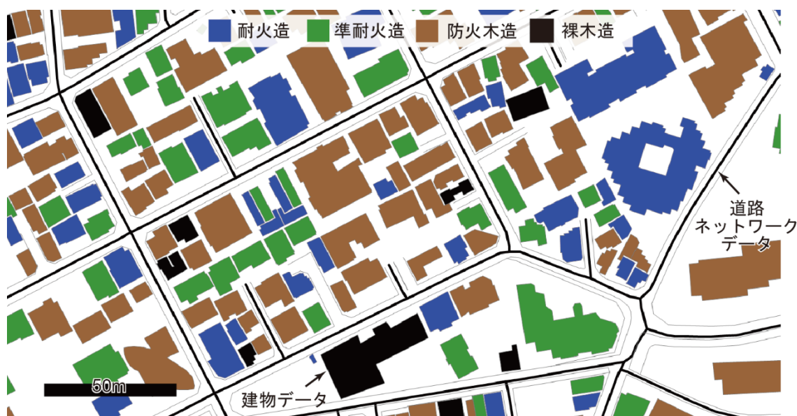
図 1.3.2-2 建物データ（防火・耐火性能）と道路ネットワークデータの例
