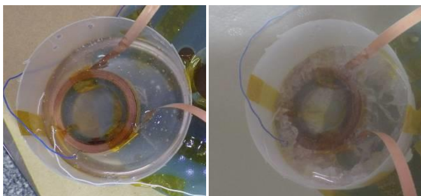
図 2.6 エポキシプレポリマー含浸 YBCO コイルの室温および冷却時の外観 (a) 室温で液体状態。(b) 冷却・固化した中に生じたクラック
