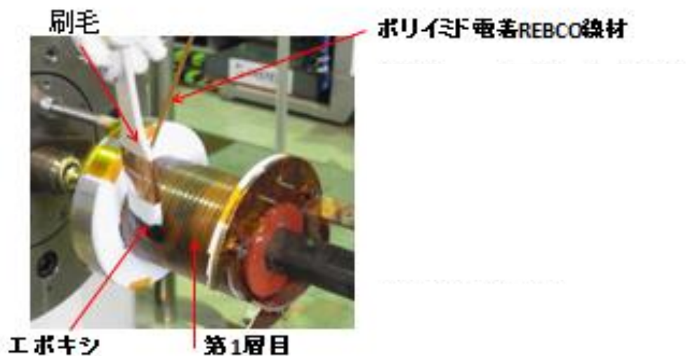
図3.8 塗り込み含浸法によるコイルの作製
