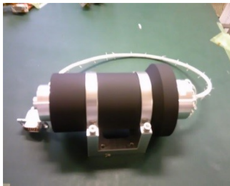
図 1.9: 超小型衛星 TSUBAME に搭載された SGCMG
