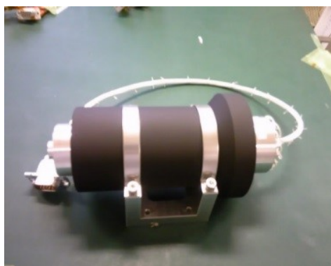
図 4.1: 超小型衛星 TSUBAME に搭載された SGCMG
