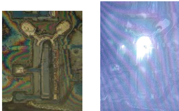
Fig.6-10 デバイスの顕微鏡写真と発振時の CCD 画像
