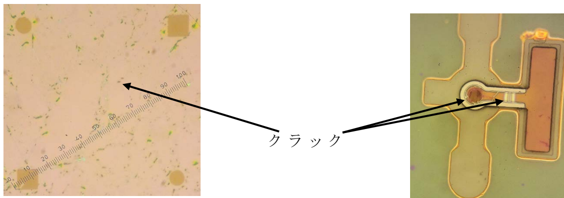
Fig.4-31 全面 \text{SiO}_2 スパッタ後の基板表面とメサ形成後の顕微鏡写真
