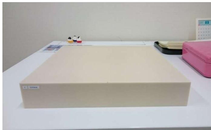
図 3.3 水等価固体ファントム (京都科学社製タフウォーターWE 型)
