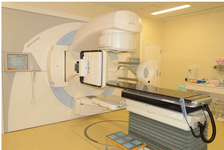
図 1.4 EBT に用いられる放射線治療システム（Elekta Synergy の例）
