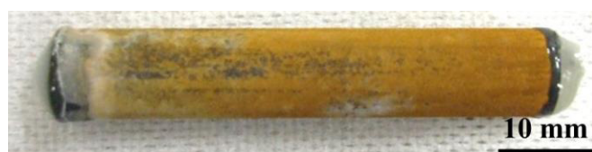
図 2-6. 劣化したコンクリートを模擬した試験溶液に 1 週間浸漬した後の鋼材
