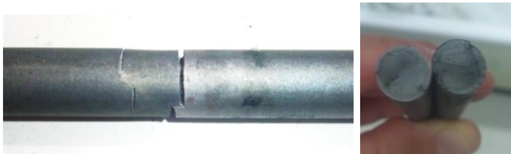
図 4-7. 水素チャージ試験片の外観 (左図：軸方向，右図：断面)
