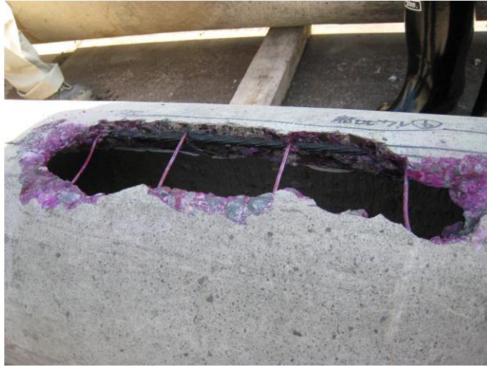
図 2-4. 実暴露 CP の中性化評価
