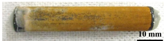
図 2-6. 劣化したコンクリートを模擬した試験溶液に 1 週間浸漬した後の鋼材
