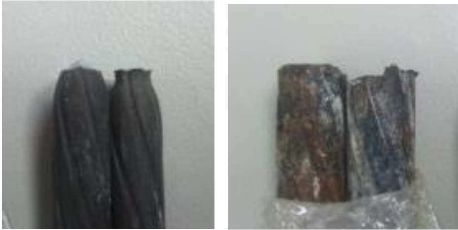
図 1-7. 健全な鋼材と水素脆化した鋼材の破断形状
