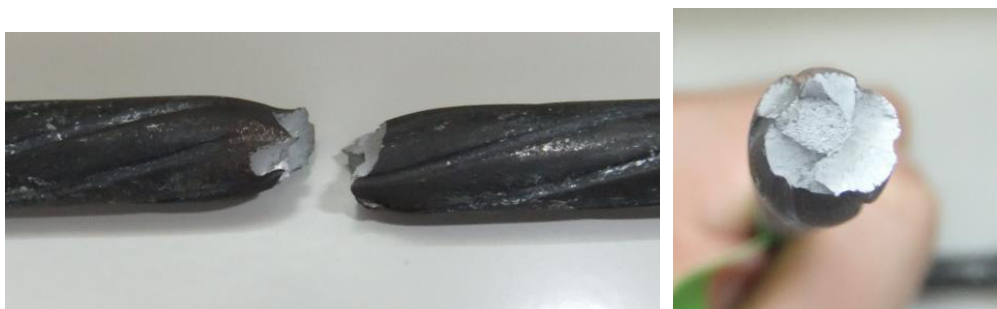
図 4-8. 水素チャージしていない試験片*の外観 (左図：軸方向, 右図：断面)
