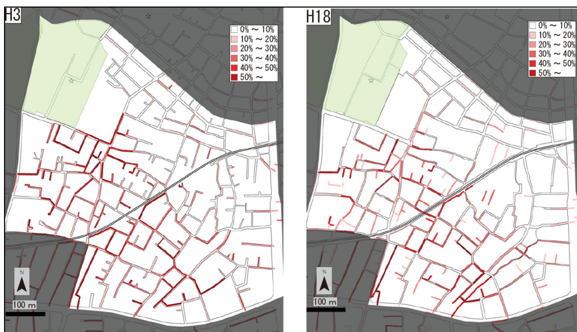
図 6.2.6 各道路の閉塞率（100 回のうち各道路が閉塞した回数の割合[推定値]）
