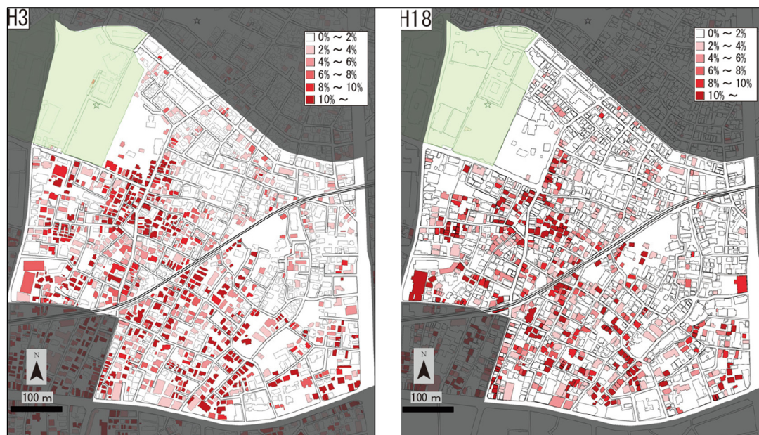
図 6.2.4 各建物の全壊率（100 回のうち各建物が全壊した回数の割合[推定値]）
