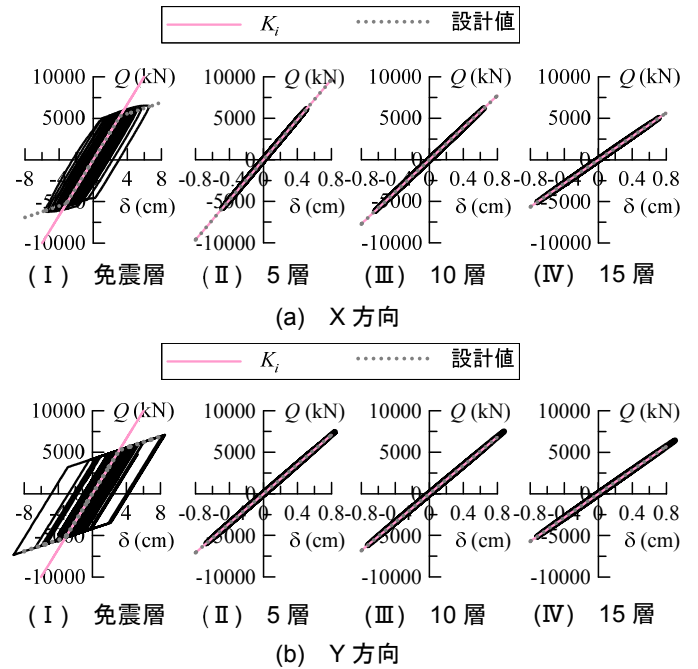
図6 上部構造の履歴曲線の比較（等価せん断型モデル）
