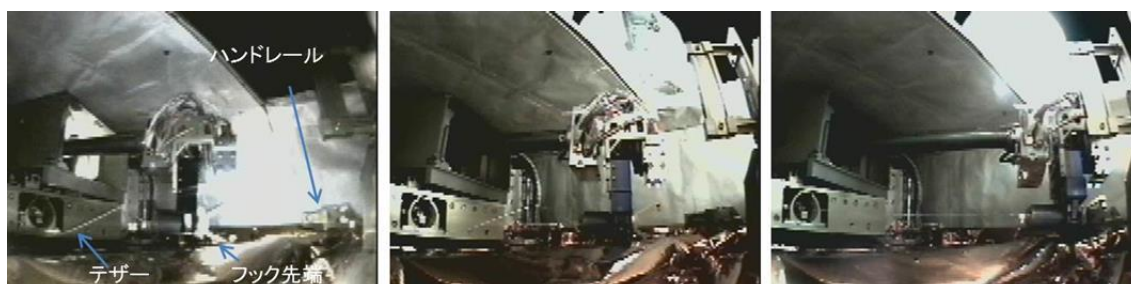
Fig. 3.15 伸展式ロボットアームによるハンドレールへのフック係留実験の様子 ©JAXA
