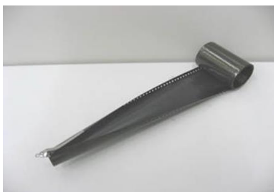
Fig. 3.9 積層 CFRP 製の STEM ©JAXA [48]
