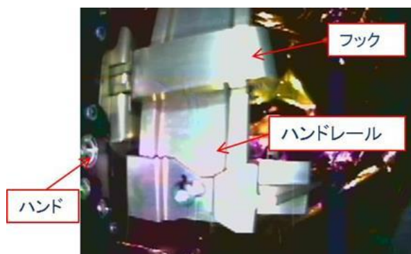
Fig. 3.14 フック係留時の小型カメラによる撮影画像 ©JAXA
