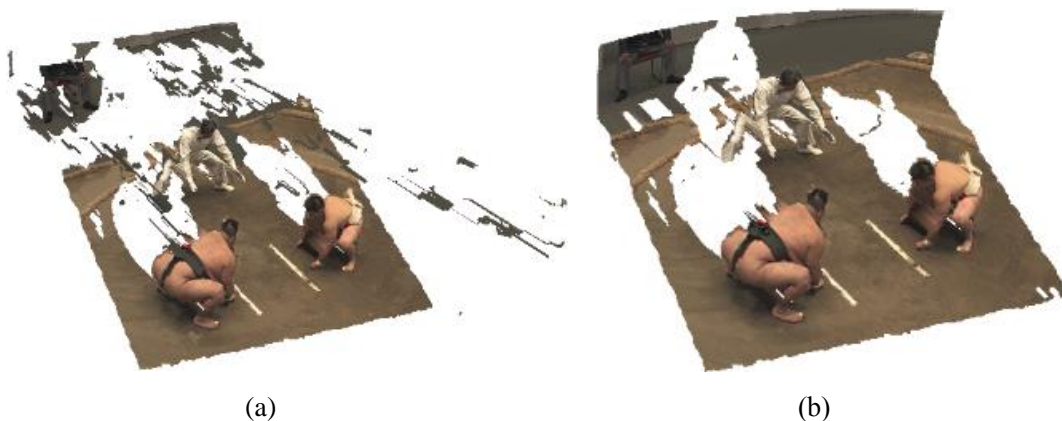
(a) (b) 図4.5 信頼度 R による3次元モデルの補正 (a) 補正なし (b) 補正あり
