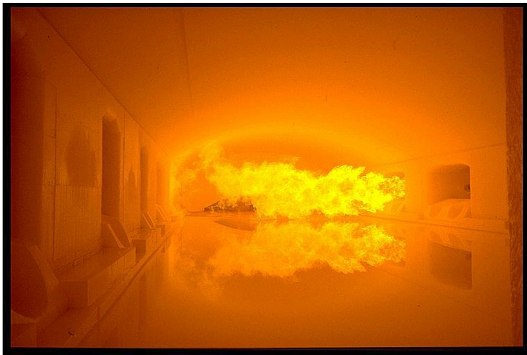
Figure 1.1: ガラス溶融炉内部の写真
