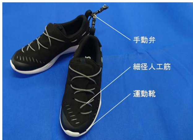
図2 細径人工筋を靴紐とした運動靴
