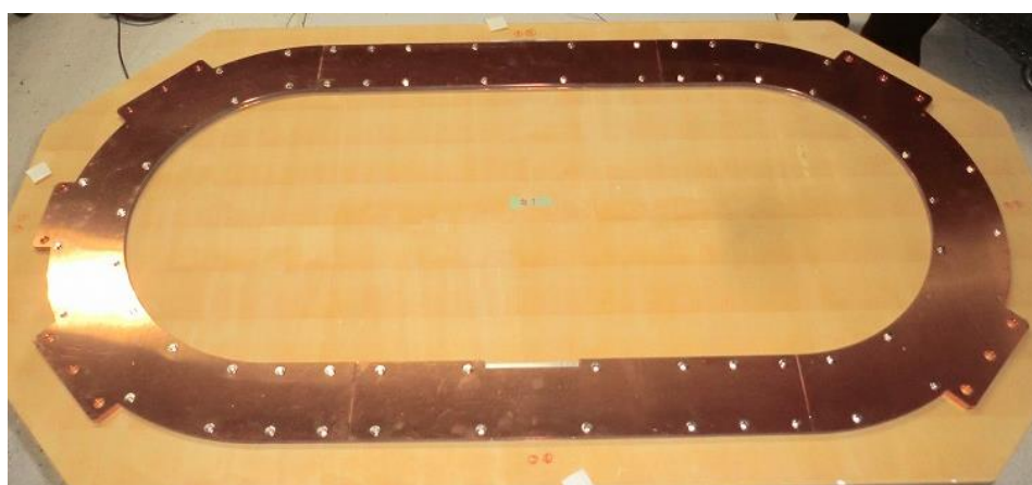
図 4-11 製作したパンケーキコイル外観
