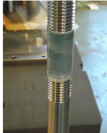
付図 8 加振ロッド PTFE テープ施工
