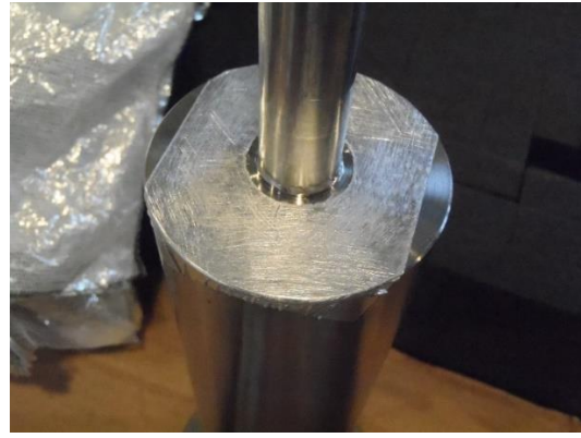
付図 6 断熱ロッド当たり面荒らし
