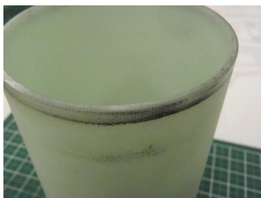
付図 3 変色した GFRP 断熱円筒
