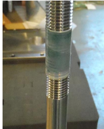
付図 8 加振ロッド PTFE テープ施工
