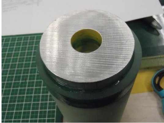
付図 5 カラーを GFRP 断熱円筒に接着
