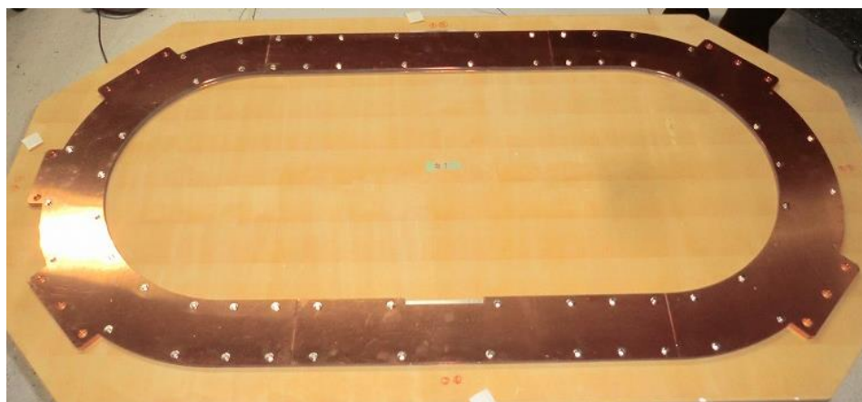
図 4-11 製作したパンケーキコイル外観
