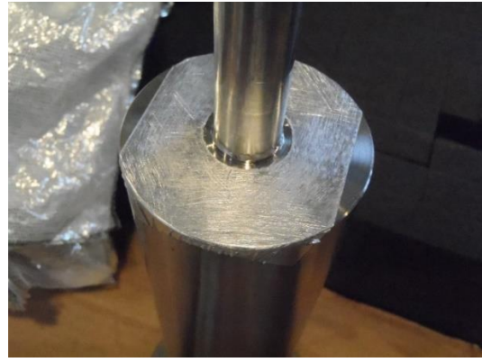
付図 6 断熱ロッド当たり面荒らし
