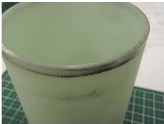
付図3 変色した GFRP 断熱円筒
