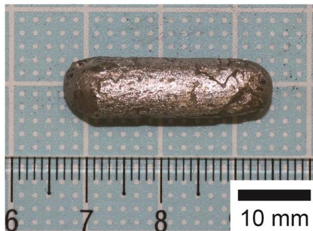
図 6.6 SS-B<sub>4</sub>C 合金外観
