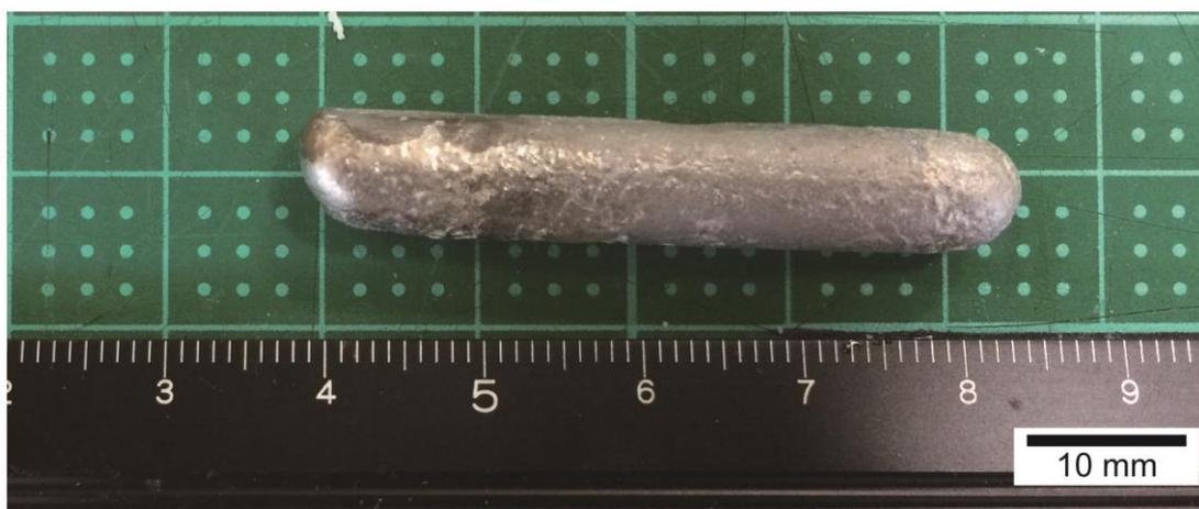
図 2.1 SS-B<sub>4</sub>C 合金外観
