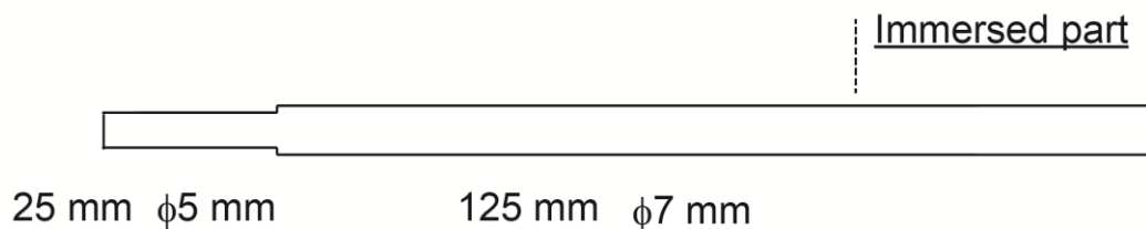
図 4.1 回転浸漬用 SS 棒状試験片模式図
