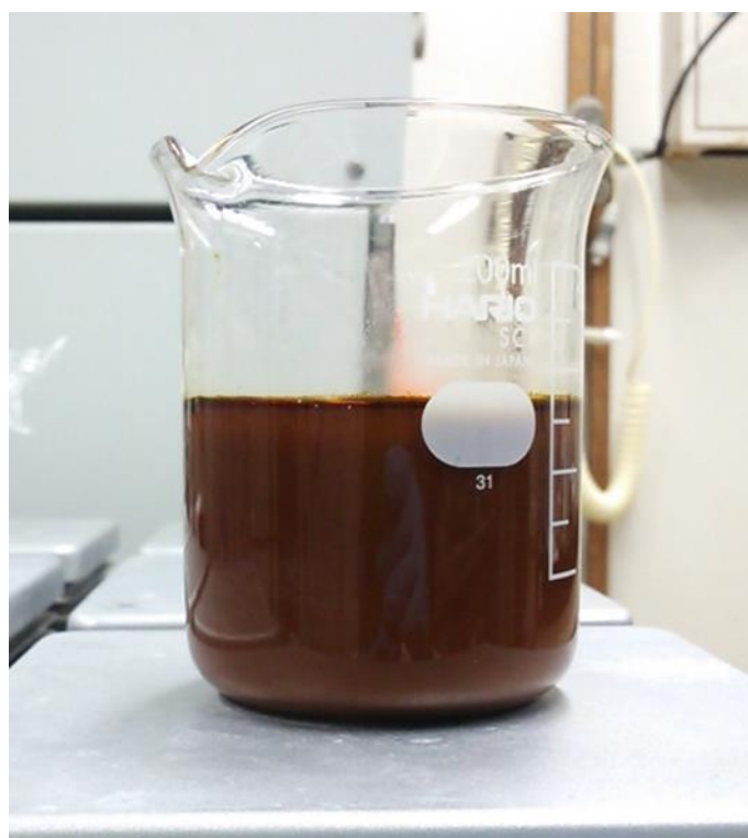
図 2-11 三ヨウ化物イオンが含まれるヨウ化アンモニウム水溶液
