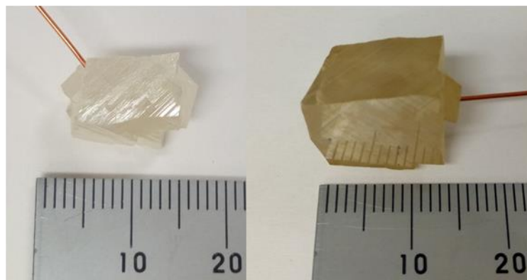
図 2-39 長期間育成したヨウ化銅単結晶、14日育成(a)と68日育成(b)。
