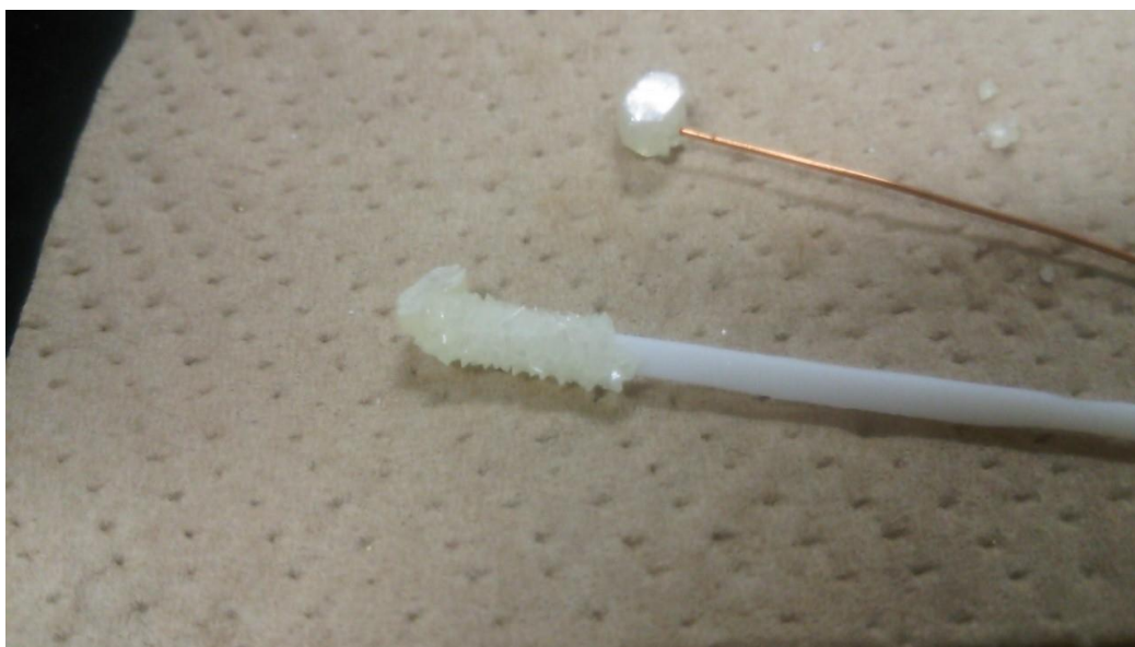
図 2-25 攪拌式結晶育成装置で育成した CuI 結晶
