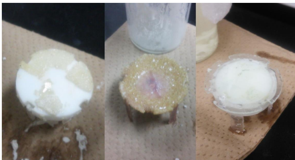
図 2-28 結晶育成後のバッフルの表面 (左から PTFE, 金属銅, ガラス)
