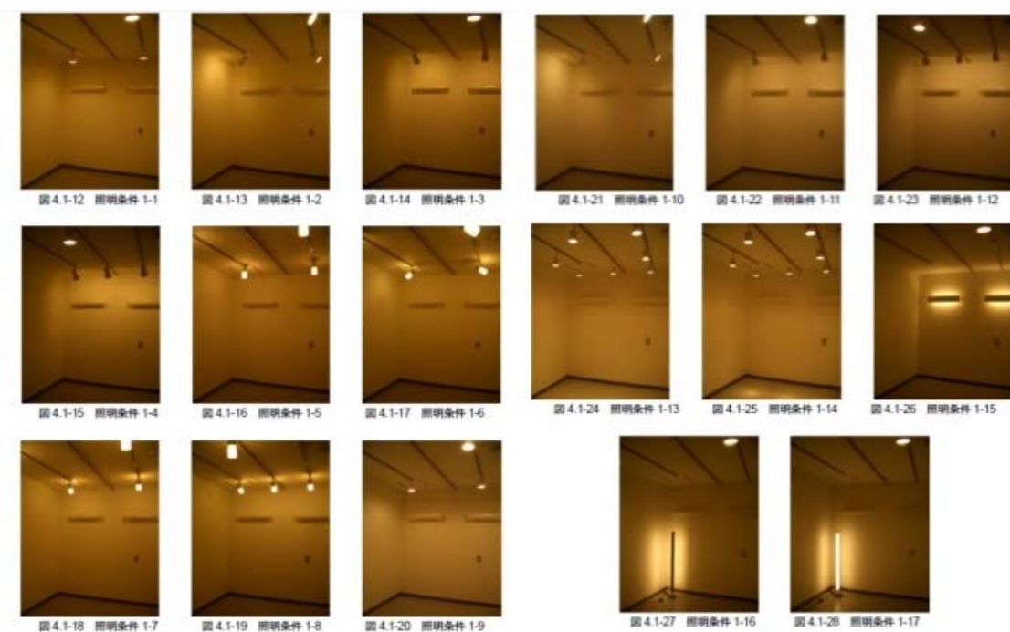
図 4-22 標準反射率内装の実験条件（出典：照明学会 2010）
