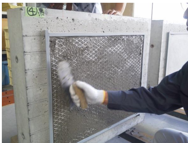
写真 2.5 補強材埋め込み状況
