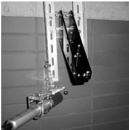
写真 2.12 鋼球振り子式打撃装置
