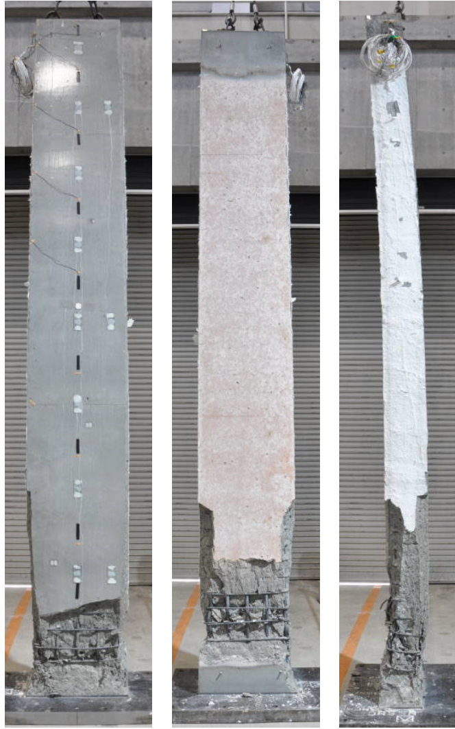
非加熱面 加熱面 断熱面 写真 4-2 実験後の試験体(H4-03-0)
