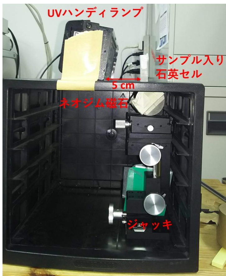
図 s-9. ネオジム磁石とジャッキと UV ハンディランプを用いた ^1\text{O}_2 生成への外部磁場効果実験のセッティング。
