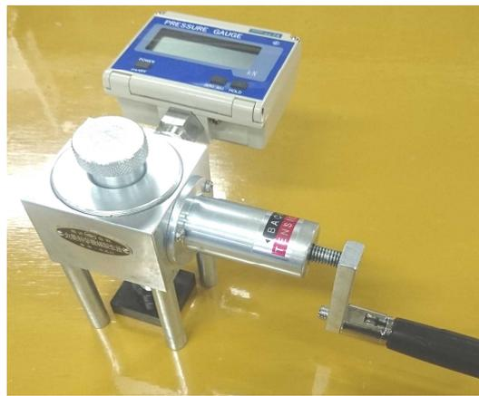
写真2.2 建研式引張接着力試験器
