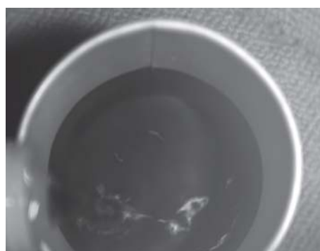
(b) 950nm のフィルタを通して赤外線カメラで撮影した水の見え
