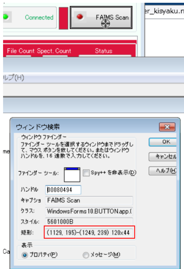
図 4-20 ウィンドウファインダーによる、コントロールの座標の取得。赤枠にコントロールの相対座標が表示される。
