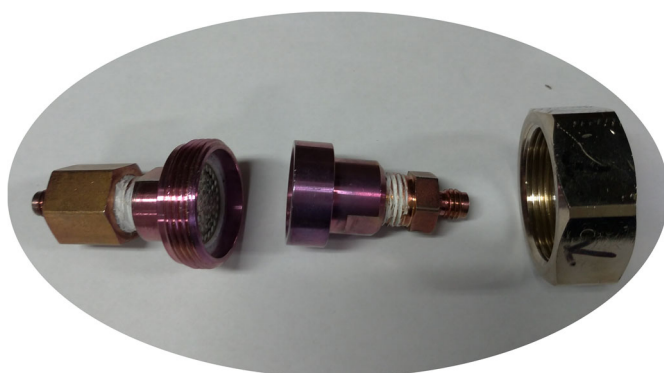
図 4-23 粒子フィルタを分解した様子（左側がメンブレンフィルタを入れる部分）
