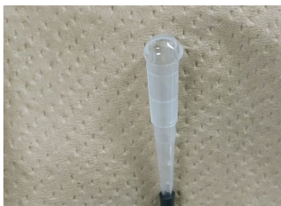
図 4-17 高速電磁弁の注入口から、気体が逆流して泡が出ている様子。チップはエタノールを入れるための容器。
