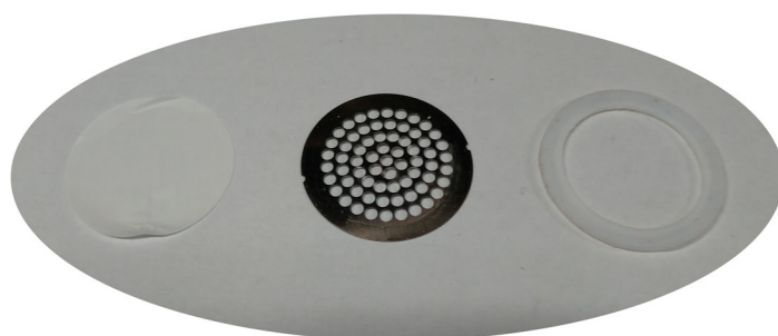
図 4-24 メンブレンフィルタ（左）、金属の抑え（中）、樹脂の抑え（右）
