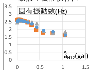
図 10 ねじれ 2 次固有振動数の振幅依存性
