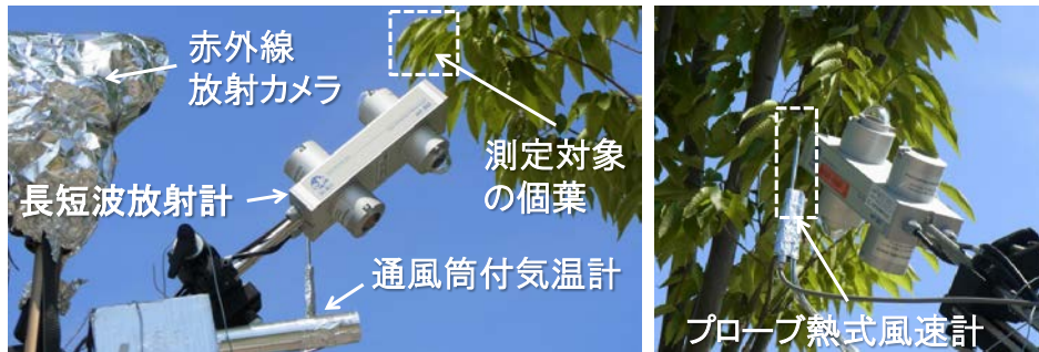
図 2-11 対象個葉と測定機器の設置
