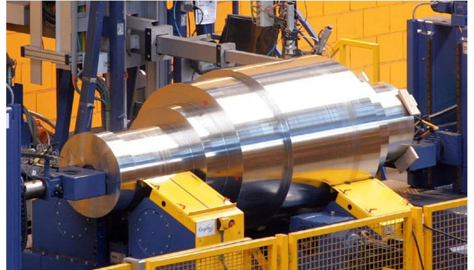
図 1.9 *TOS1X-2* の大型鍛造素材の製造実績: (a) 製品重量14ton, (b) 製品重量26ton<sup>[14],[15],[46],[47]</sup>
