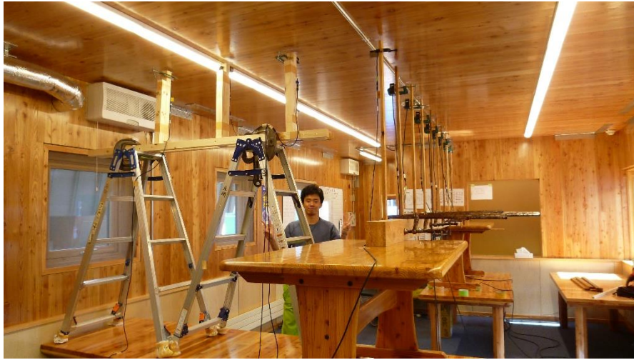
(a) 変位計設置の様子
