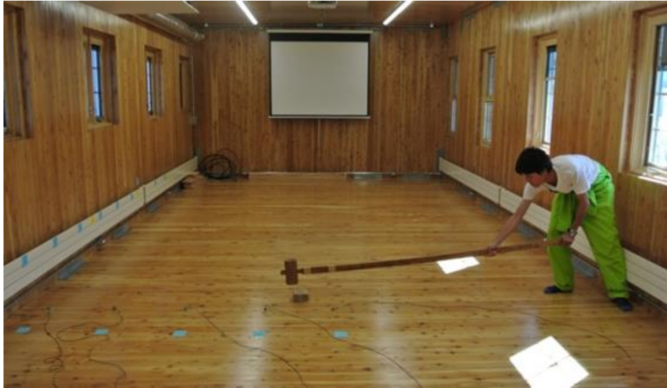
写真 3.5 動的加振試験の様子(振動モード測定)
