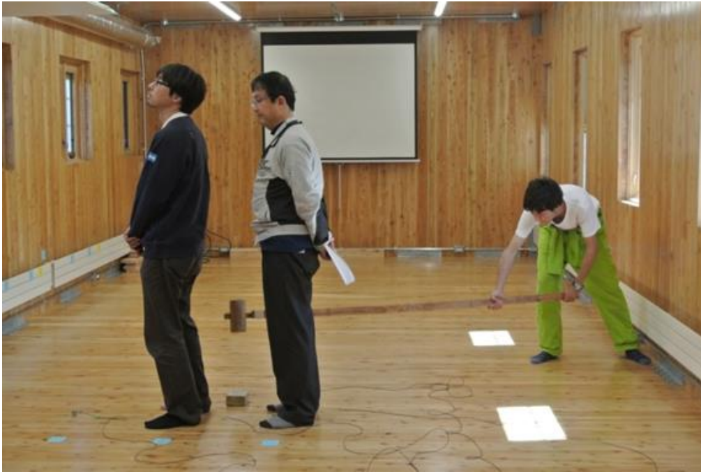
写真 3.6 動的加振試験の様子(減衰測定, 床上 2 人の受振者の場合)
