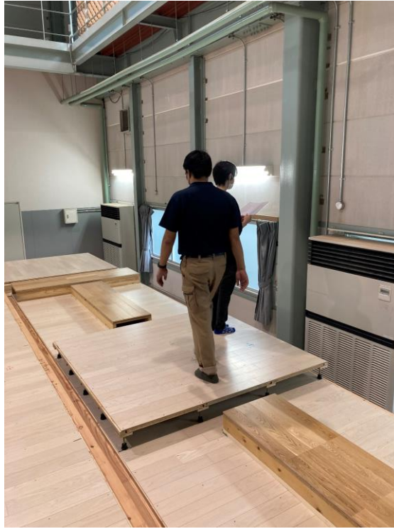
写真 2.4 試料床検査の様子
