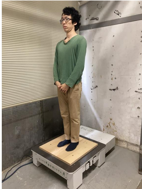
写真 2.5 振動台検査の様子
