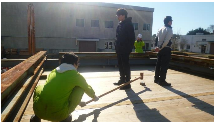
写真 3.14 動的加振試験の様子 (減衰測定, 床上 2 人の受振者の場合)
