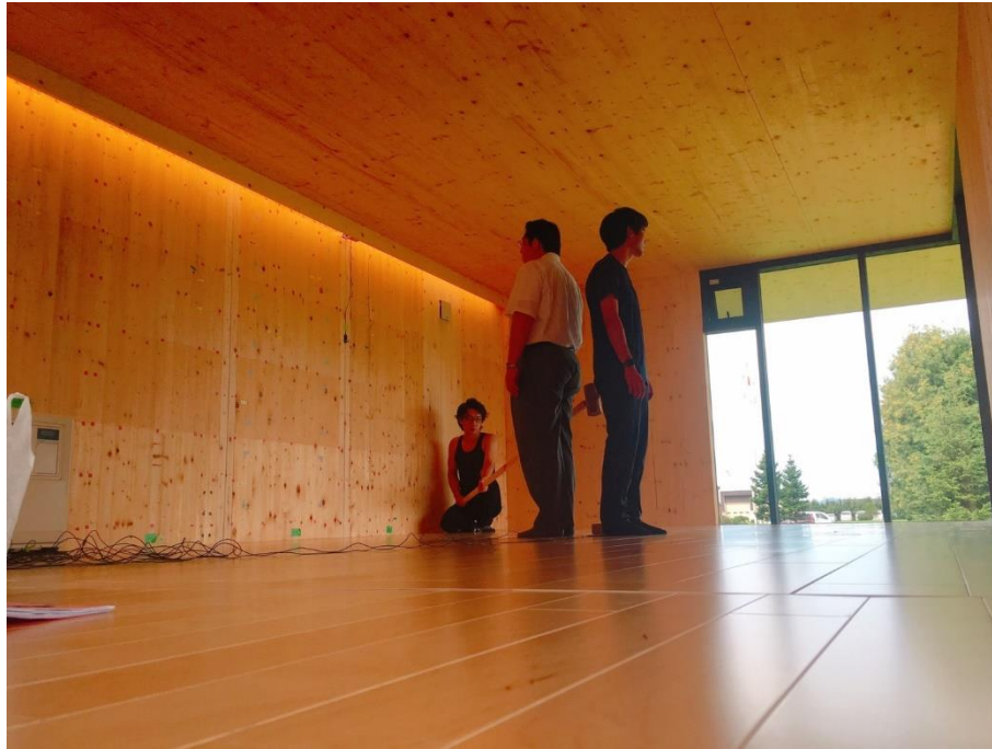
写真 4.5 動的加振試験の様子(減衰測定)
