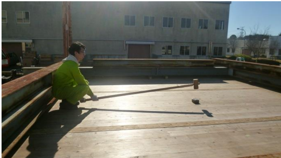
写真 3.13 動的加振試験の様子 (固有振動数測定)
