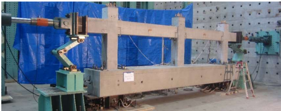
写真 3.1: 荷重装置およびセットアップ状況
