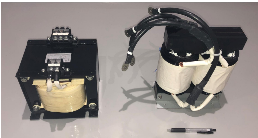
図 1.3: 重量 26 kg の珪素鋼板を使用した单相 100-V 3-kVA 50-Hz 変圧器（左側）と重量 11 kg のファインメットを使用した单相 750-V 100-kVA 16-kHz 変圧器（右側）の外観
