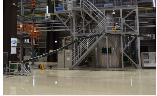
図 1 全長 10 m 長尺多関節アーム: Super Dragon
