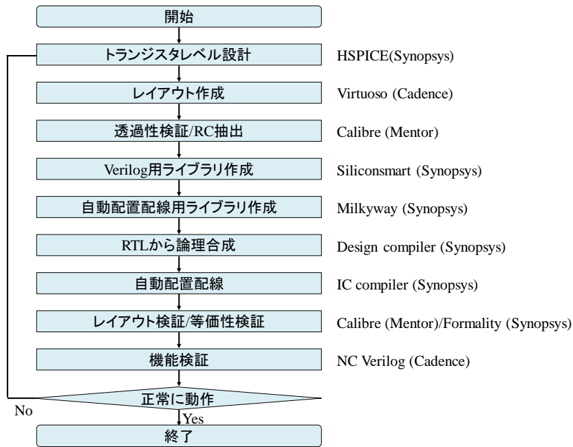
図 4.6.1 VNR-SRAM マクロの設計フローと使用した設計ツール
