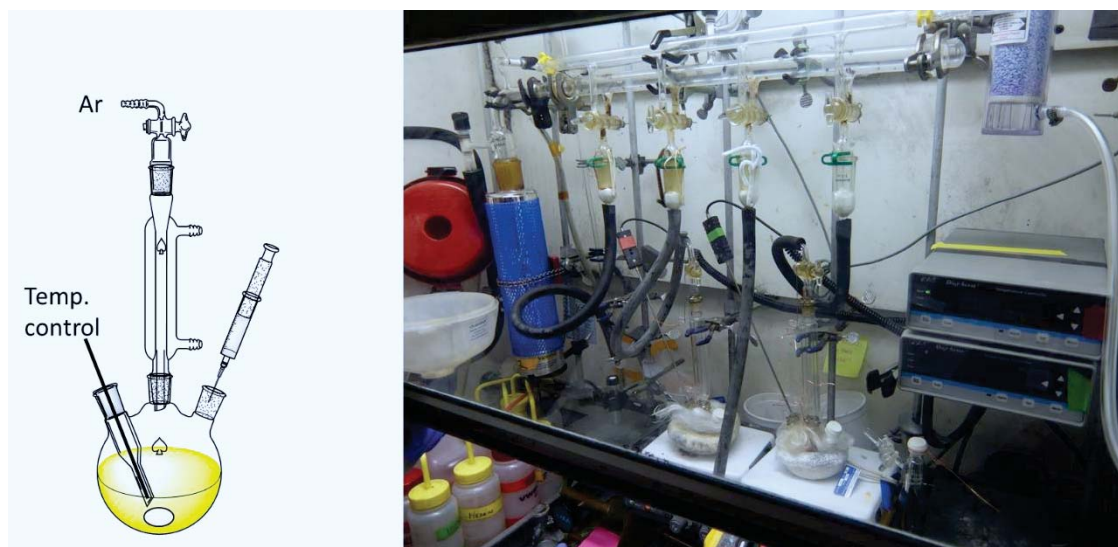
図6. 1. 1. 1 ホットソープ法による合成 左：合成時のガラス器具構成、右：実際の反応系の外観図
