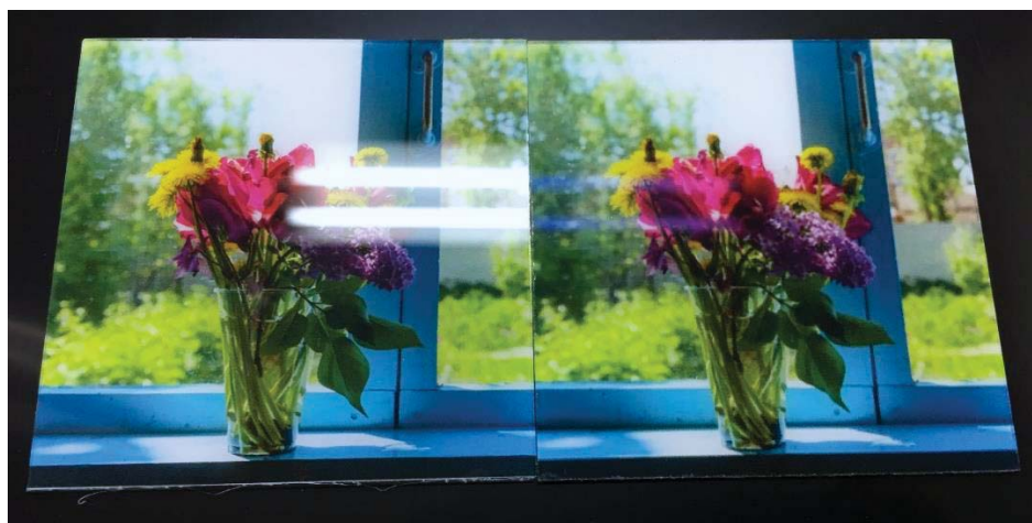
図5. 3. 3. 2 ガラス表面に G4 反射防止膜を付与した際の反射性 (左：表面加工なし、右：表面加工あり)
