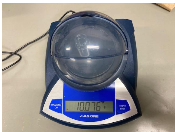
図 5.2-5 電子微量天秤でエタノールの重さを計測（バイアル瓶の差分重量から計測）
