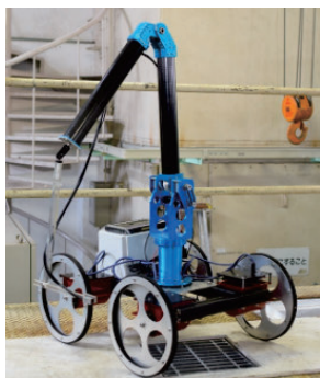
図5 ロボットを用いた遠隔計測システム例 (ロボットアーム型) 4)
