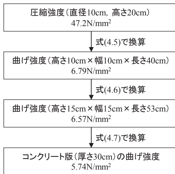
図-4.22 コンクリート版の曲げ強度の推定フロー
