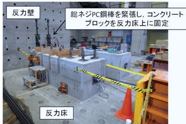
d) コンクリートブロックの固定状況（試験開始前）
