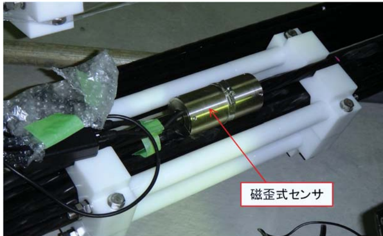
図 2.1-4 磁歪式センサの外ケーブルへの取り付け状況の例
