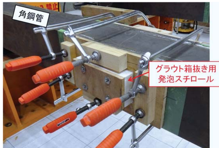
b) 角鋼管開口付近のグラウト用型枠
