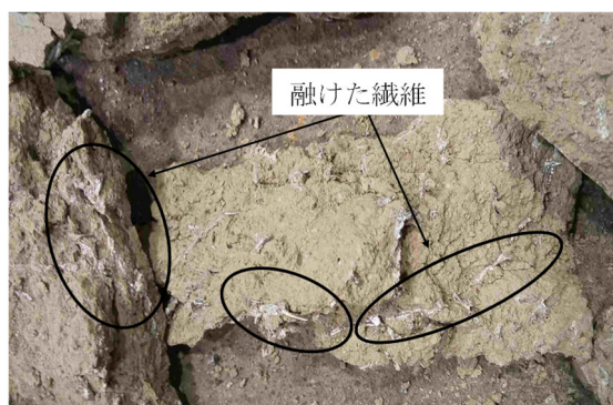
図-10 高温下荷重後のアルミニウム繊維補強コンクリート内部
