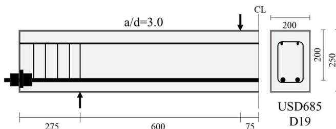
図 1 試験体形状および寸法
