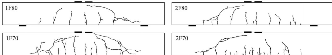
図 2 疲労試験体ひび割れ分布図
