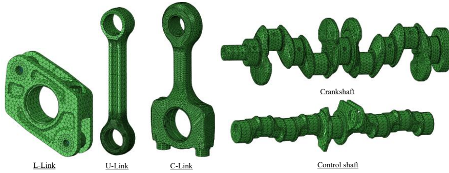
図 4-20:6 節可調整ピストン・クランク機構の構成部品の FEM モデル
