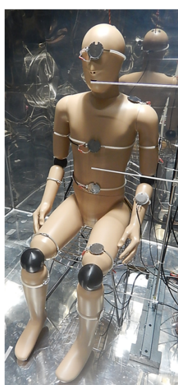
図 4-10 サーマルマネキンに対するシリコンウエハの設置位置と設置角度 \theta
