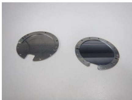
写真 4-3 シリコンウエハホルダー(左：ホルダーのみ, 右：ウエハ設置時)
