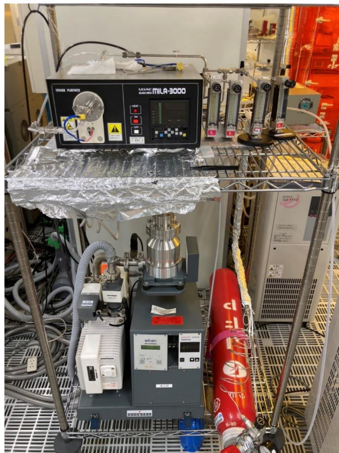
図3-5 平坦化アニール装置
