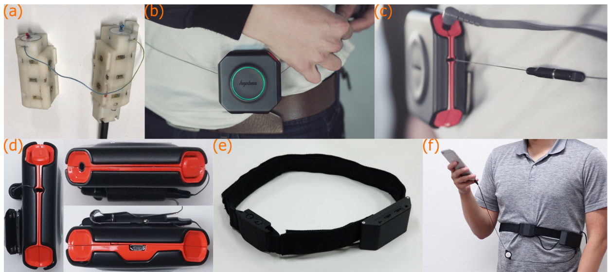
図 4.1 胴巻き付け型のプロトタイプ写真。(a) Euro Haptics 2016 でデモを行った巻き付け型（アクチュエーター部分のみ、別途駆動用アンプが必要）(b) (c) 巻き尺型の装着図。(d) 巻き尺型の側面図。(e) ベルト型。(f) ベルト型装着写真。
