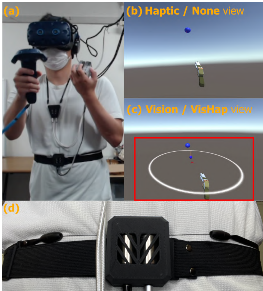
図 6.1 実験環境。(a) Hapbeat の装着含む実験中の参加者の様子。(b) Haptic・None 条件の VR 環境。(c) Vision・VisHap 条件の VR 環境。図中の赤枠は定義したレーダー描画範囲(6.4.8 節で説明)。(d) ベルト型装置の外観
