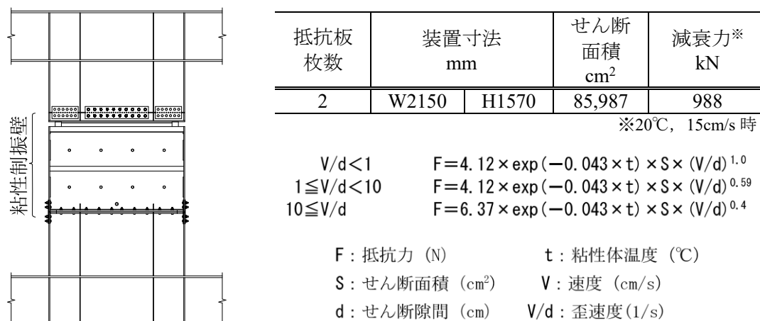
図 5.17 粘性制振壁 4) の概要
