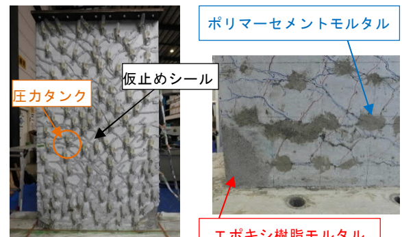
エポキシ樹脂注入
