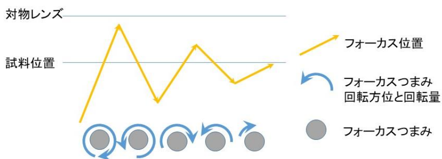
図 4-2-2 試料と対物レンズの相対位置およびフォーカス名称。 ①アンダーフォーカス ②ジャストフォーカス ③オーバーフォーカス
