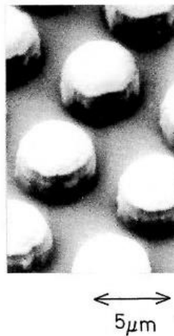
図 4-4 GaAs 基板上の直径 5 μm SiO 2 /TiO 2 の 7 ペアの誘電体多層膜反射鏡の SEM 写真 [Matsutani, 1991]
