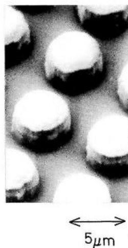
図 4-4 GaAs 基板上の直径 5 \mu\text{m} SiO 2 /TiO 2 の 7 ペアの誘電体多層膜反射鏡の SEM 写真 [Matsutani, 1991]
